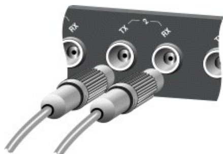
ภาพที่ 7.3 ตัวอย่างการต่อสายชนิด Connector แบบ ST
