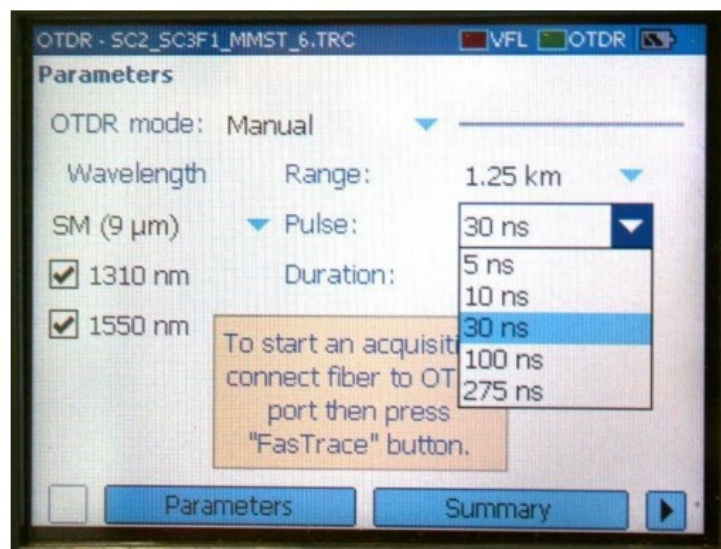
ภาพที่ 8.4 ตัวอย่างการกำหนด Pulse คือค่าความยาวคลื่นที่จะใช้ในการส่งสัญญาณ
